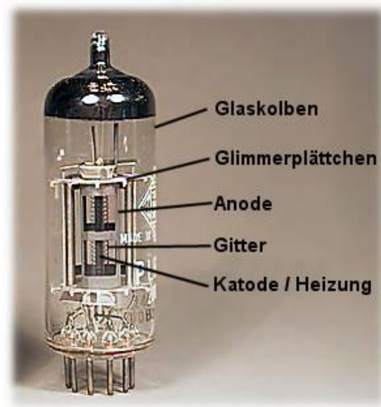
Bild 6: Reale Röhre am Beispiel der PL802 (Pentode, aber nur 1 Gitter gut sichtbar)
