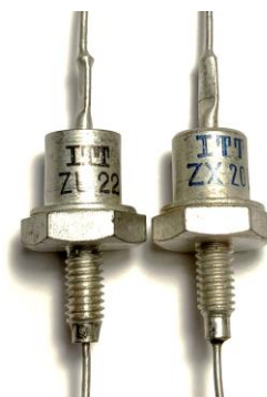
Abb. 2: Baugleiche Zenerdioden von ITT
