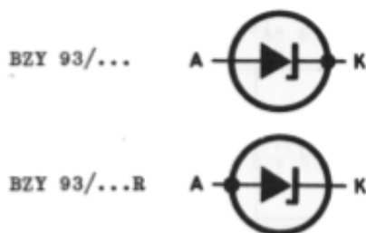
Abb. 5: Die zwei verfügbaren Polungen der BZY93
