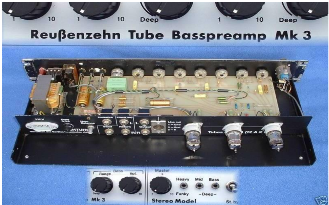
Bild 2: Rückseite mit den Buchsen Footswitch, Eff.-Send, Eff-Return L&R, Out L&R, Line out, Hum-Regler , 3 Röhren mit Sockel
