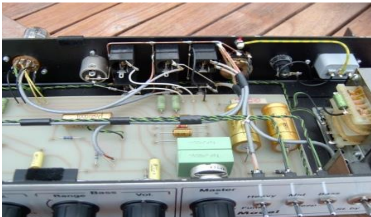
Bild 6: Die großen grünen Kondensatoren bilden die Ausgangskapazität 1\mu\text{F}/400\text{F} . Die Schalter für Mid-Boost und Bass Boost sollten mit ca. 100\text{k}\Omega „Entknackst werden. Umschalten im Spielbetrieb ist sonst sehr unschön. Der XLR Ausgang ist praktisch unbrauchbar da unsymmetrisch und noch mit 100\text{k}\Omega in Serie. Dann lieber einen der Stereoausgänge mit passivem 10:1 Übertrager (passive DI-Box) benutzen.
